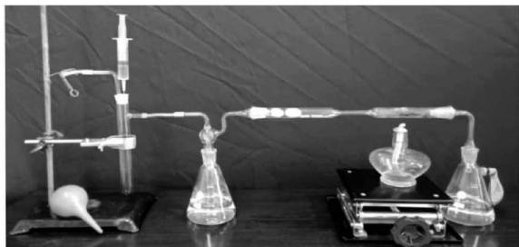
图2 \text{Cl}_2 制备和性质检验一体化实验装置
