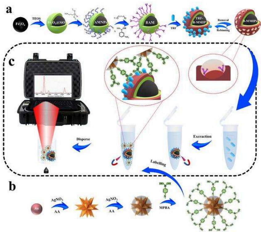
双硼酸亲和“三明治”SERS生物传感器的构建原理。（a）硼酸亲和磁性表面分子印迹聚合物的制备过程；（b）硼酸功能化SERS纳米标签的制备过程；（c）构建
